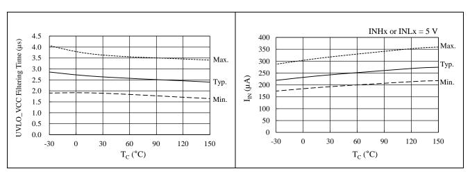
Figure 15-11. UVLO\_VCC Filtering Time vs. T<sub>C</sub>
