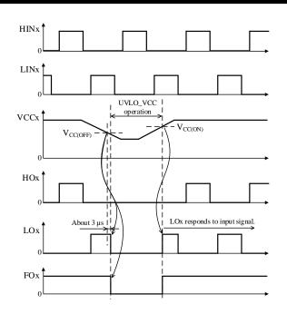
Figure 12-14. UVLO\_VCC Operational Waveforms
